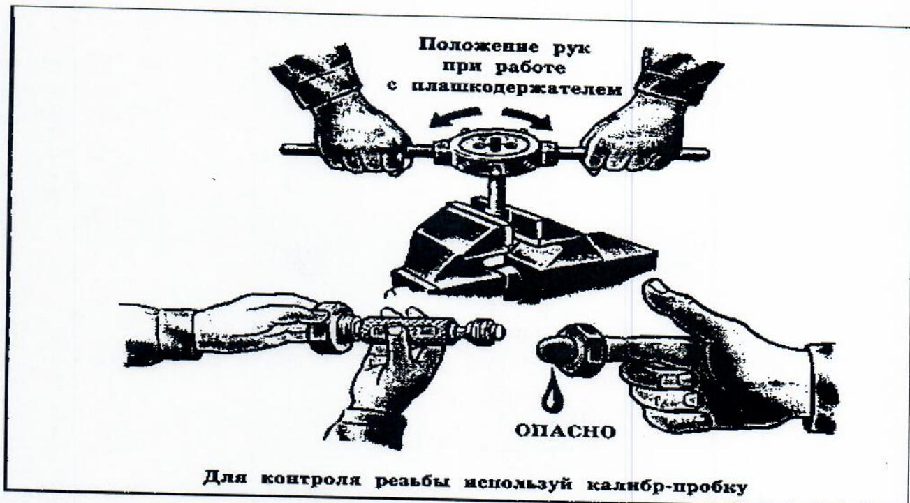
*Рис. 10. Правила безопасности при нарезании резьбы*
