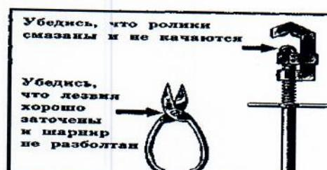
Рис. 8. Требования к ножницам и труборезам
