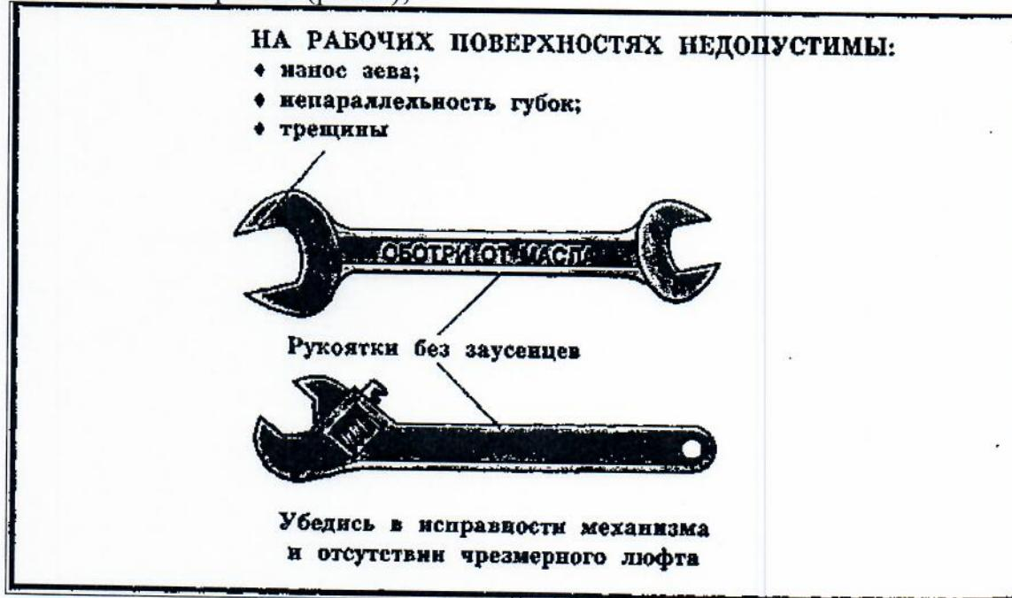
Рис. 3. Требования к гаечным ключам
